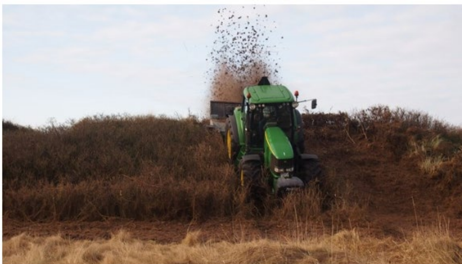
Traktor med monteret biorotor i fuld gang med rydningen på Agger Tange
